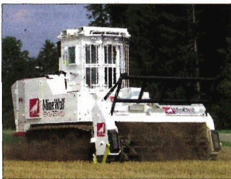
Гусеничная машина «Миневольф» имеет массу 26,6 т. Глубина разминирования составляет 35 см, ширина колеи – 2,8 м. В среднем за сутки она способна обработать территорию площадью от 15 до 25 тыс. м<sup>2</sup> в зависимости от свойств грунта.
