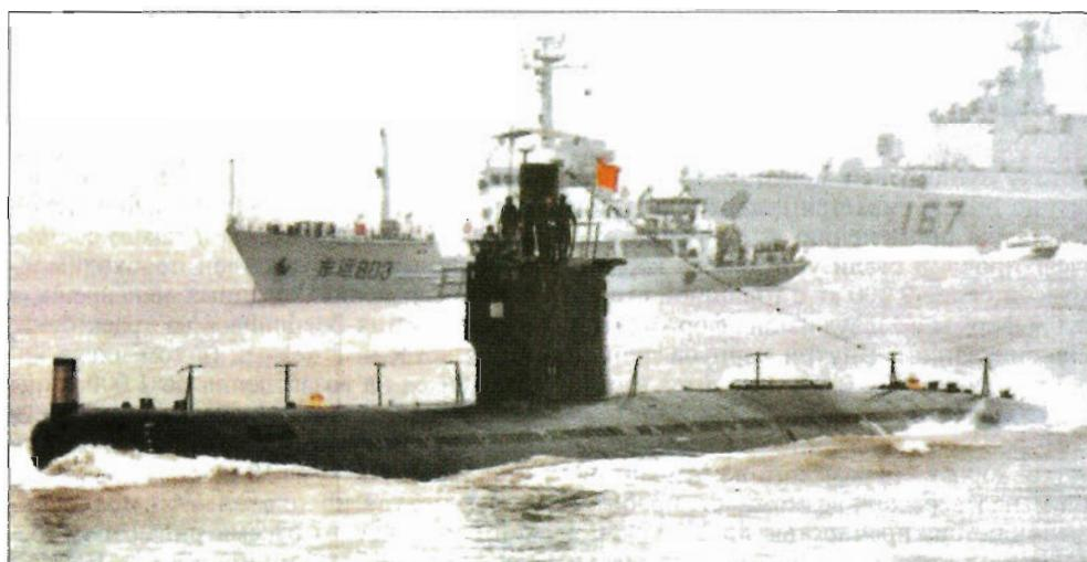
Дизель-электрическая подводная лодка типа «Ромео» (пр. 033)
