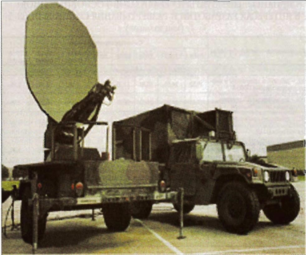
*Мобильная станция спутниковой связи специального назначения AN/TSQ-190(V) Trojan SPIRIT-2*
