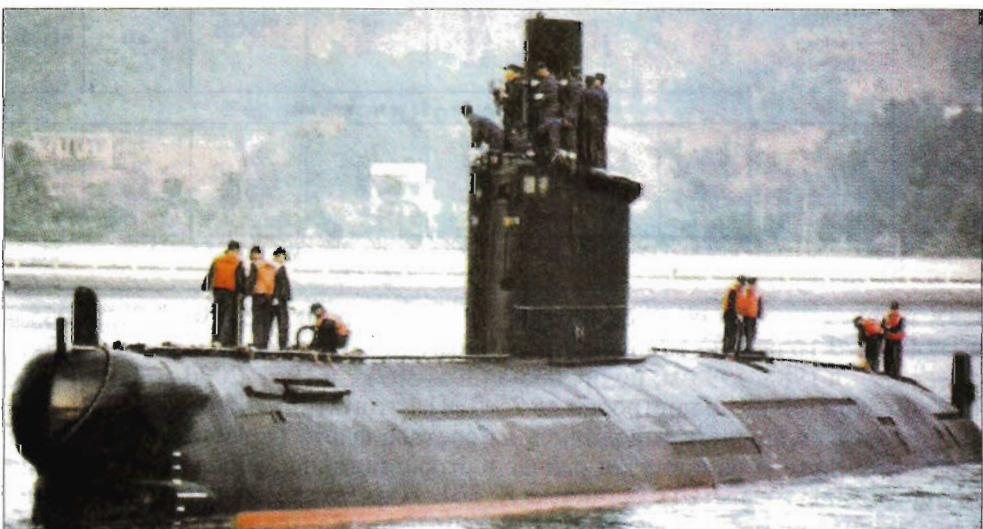
Дизель-электрическая подводная лодка типа «Мин» (пр. 035)
