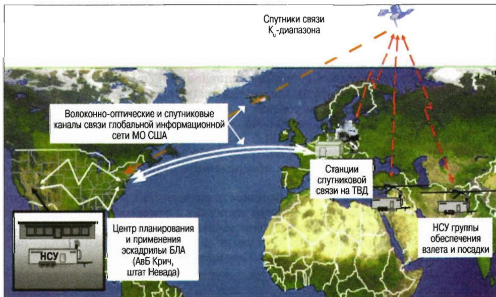
*Схема организации управления многоцелевыми БЛА MQ-1 «Предатор» и MQ-9 «Рипер» ВВС США на ТВД*
