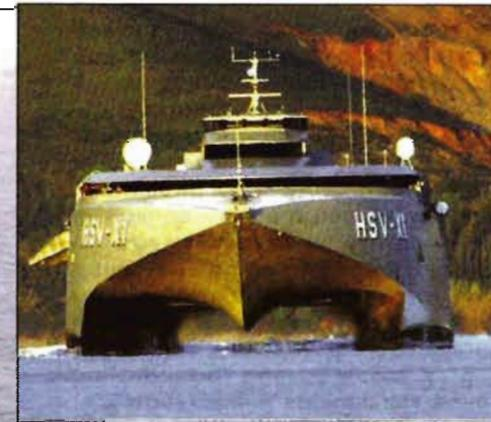
АМЕРИКАНСКИЙ МНОГОЦЕЛЕВОЙ КАТАМАРАН ВОЛНОРЕЗНОГО ТИПА HSV-X1 «ДЖОЙНТ ВЕНЧЕР» построен компаниями «Боллинджер» и «Инкэт» в г. Локпорт (штат Луизиана). С 2001 года корабль используется в основном для проведения испытаний и отработки различных концепций в интересах в том числе командований автобронетанковой техники сухопутных войск, сил
